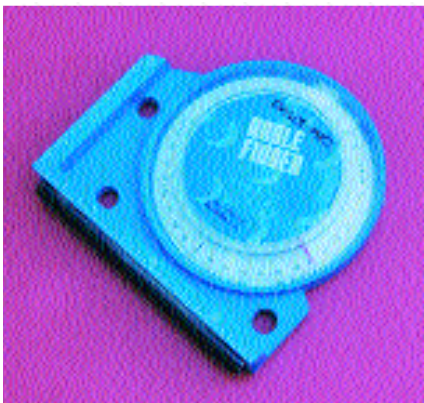
Un simple goniómetro puede sernos muy útil para calcular los ángulos a los que nos enfrentamos. Un trozo de tubo de flecha unido a él nos puede ayudar en el cálculo de la horizontal.
